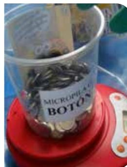
Pesaje de muestras de pilas según clases y subtipos
