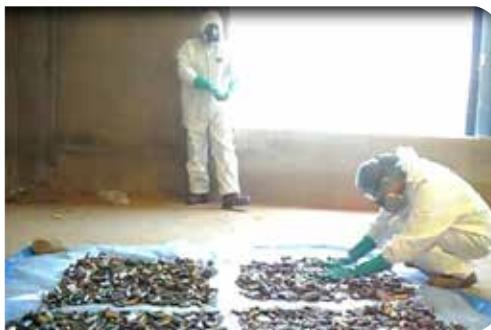
Homogenización y cuarteo de las muestras de pilas y baterías
